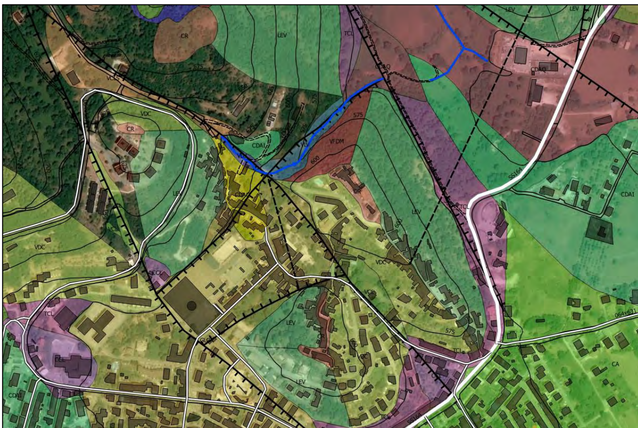
Figura. Stralcio Carta geomorfologica del Centro urbano con indicazione dei lineamenti tettonici (Legenda: LEV - Versante Strutturale, CDAQ - Conoide Detritico -Alluvionale Quiescente, CDAI -Conoide Detritico-Alluvionale Inattiva, VDC-Versante Denudazionale, VCLS - Vallecola a fondo concavo sospesa, VLV - Vallecola a V, VFDM - Versante fluvio-denudazionale di bacino imbrifero montano, CR-Crinale, GCLS-Glacia di accumulo)
