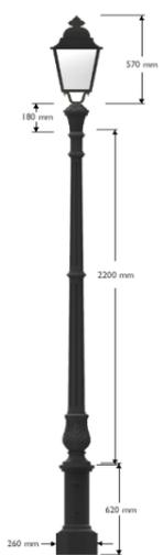
Palo in ghisa verniciato di colore nero antracite. Costituito da un elemento centrale cilindrico su base ottagonale e lanterna a sezione quadrata con ottica LED.
