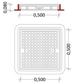
Chiusino in ghisa sferoidale a norma ISO 9002/EN 29002 conforme alla normativa UNI-EN 124 dims. 50\*50.
