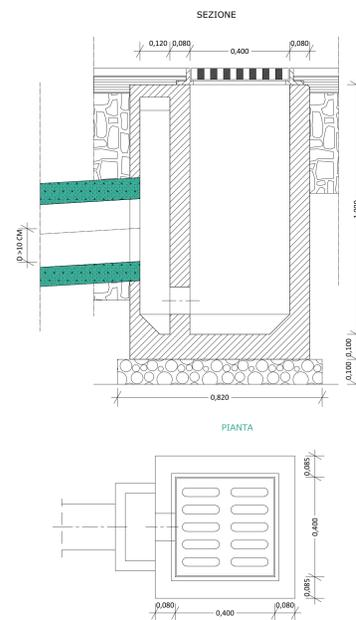
POZZETTO DI ISPEZIONE CON CHIUSINO IN GHISA SCALA 1:10
