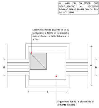
SEZIONE TIPO DI POSA TUBAZIONI IN SEDE STRADALE FOGNATURA IN CALCESTRUZZO SCALA 1:20 Ripristino della sede stradale esistente
